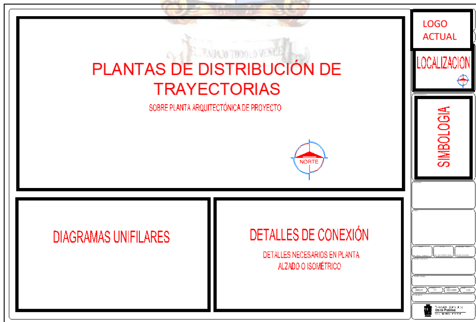
Fig. 13.09. Plano llave para proyecto de CCTV, voz y datos
