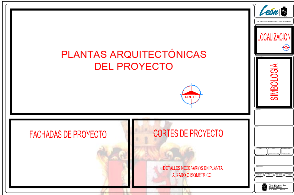
Fig.13.06 Plano llave para proyecto arquitectónico
