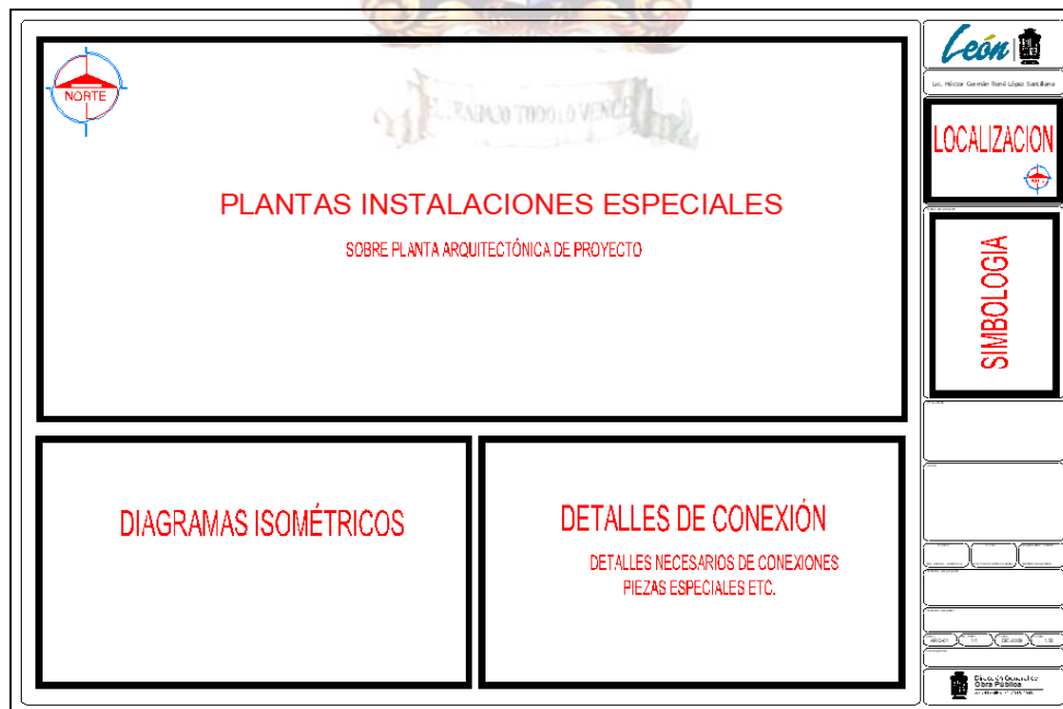
Fig. 13.11. Plano llave para proyecto de instalaciones especiales.
